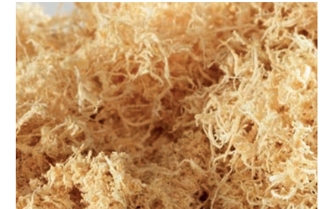
Ausgerissene Fasern beim Staub der Wettbewerber.
